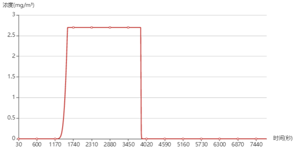
图 7.6-18 最不利气象条件下 SLAB 模型二甲苯近距离敏感点（赵堤村）浓度时间分布示意图
